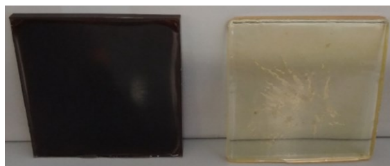
Obr. 1: Fotografia vzorky čistého polyméru (vpravo) a polyméru s prídavkom drevného prachu (vľavo)
