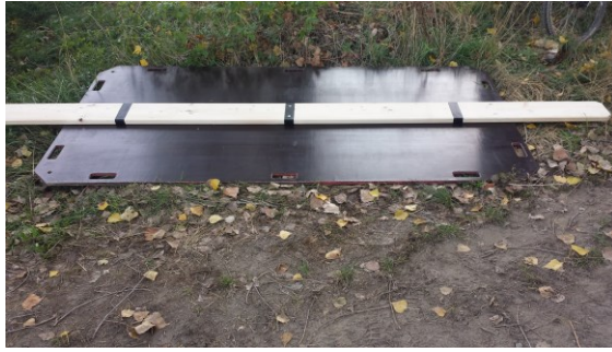
Obr. 4 Oporná doska systému PARATECH [autor]
