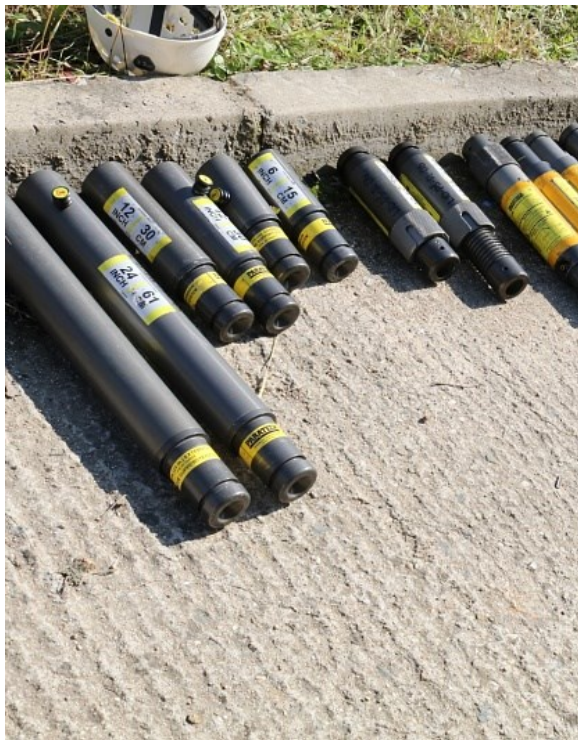
Obr. 5 Stabilizačné tyče PARATECH [autor]
