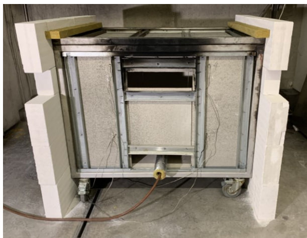
Obr. 3: Středněrozměrová požární pec s čelními stěnami z pórobetonových tvárnic s instalovanými zkušebními vzorky
