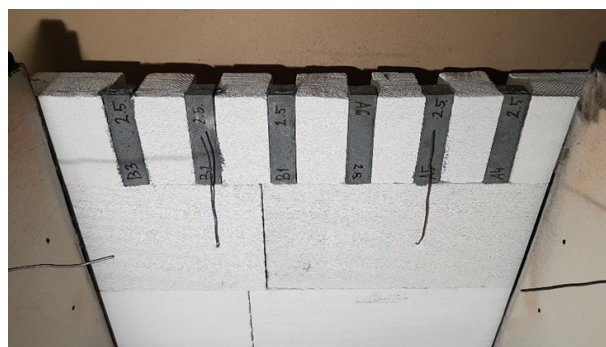
Obr. 2: Uchycení trámečkových vzorků v čelní stěně pece z pórobetonových tvárnic
